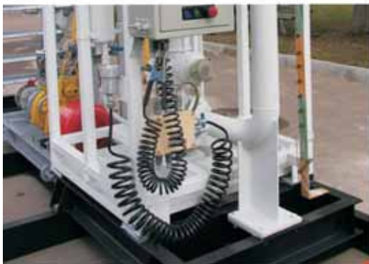
Клеши заземления
