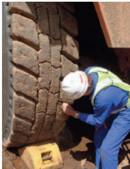
Не рекомендуется продолжать эксплуатацию шин, имеющих видимые повреждения бортовой зоны, расслоения компонентов шины, видимые тросы каркаса или бортового кольца, повреждения от электротока или химических продуктов, а также имеющих повреждения внутреннего герметизирующего слоя резины. Регулярно проверяйте состояние колпачков и золотников, при необходимости замените.
