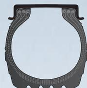
**Каркас в зоне протектора и боковины имеет одинаковую конструкцию**
