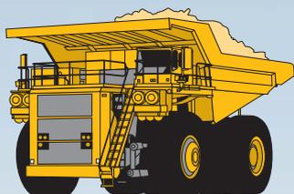
Данный тип самосвалов используется в основном на разрезах и крупных стройплощадках. Условия эксплуатации могут значительно отличаться: от особо абразивных, с высокой степенью износа и участками короткого плеча откатки, до относительно высоких скоростей и участков большого плеча откатки.
