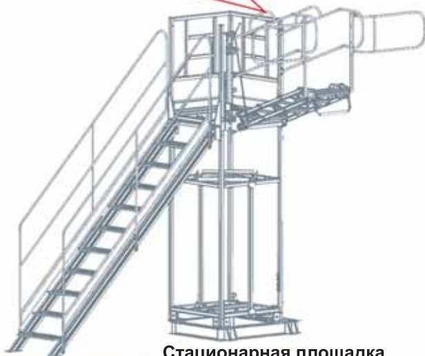
Стационарная площадка обслуживания автоцистерн
