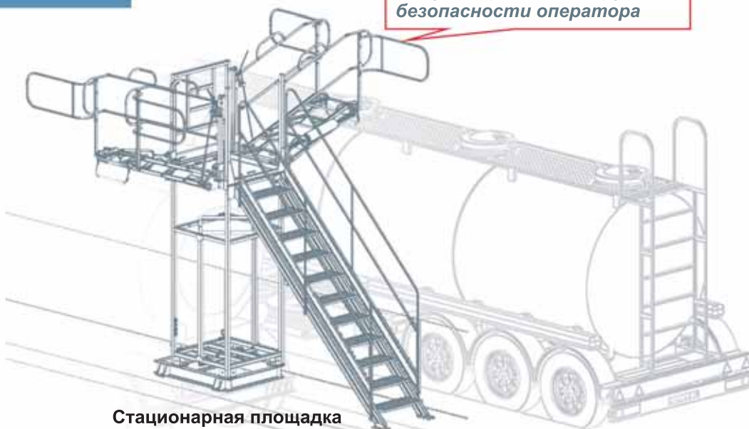
Стационарная площадка обслуживания автоцистерн
